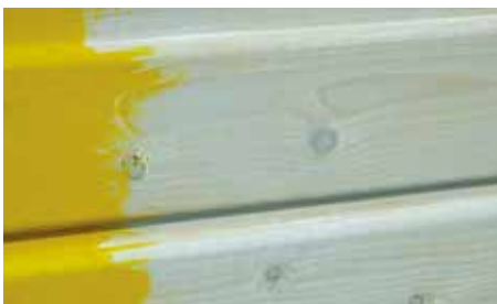
Sperrgrund – schützt vor durchschlagenden Inhaltsstoffen (Seite 182)
