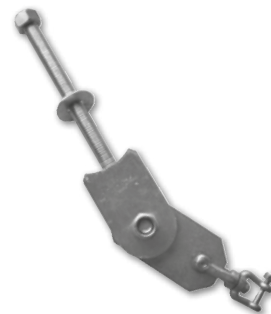
22 Schwinghaken verzinkt, mit Kugellager in einer 10 mm dicken Stahlplatte. Nylonlager (außen Ø 15 mm, innen Ø 6 mm) für die Befestigung von Ketten, Gesamtlänge 160 mm, Gewindestange mit M14-Sicherheitsmutter, Schäkel mitgeliefert.
