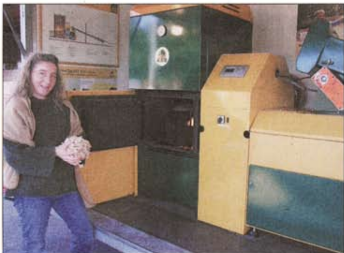
Telse Böge von der Firma Bio-Energie-Systeme Christian Böge aus Nützen zeigt eine Holzschrotel-Heizanlage, die so einfach zu bedienen ist, wie eine Ölheizung.
